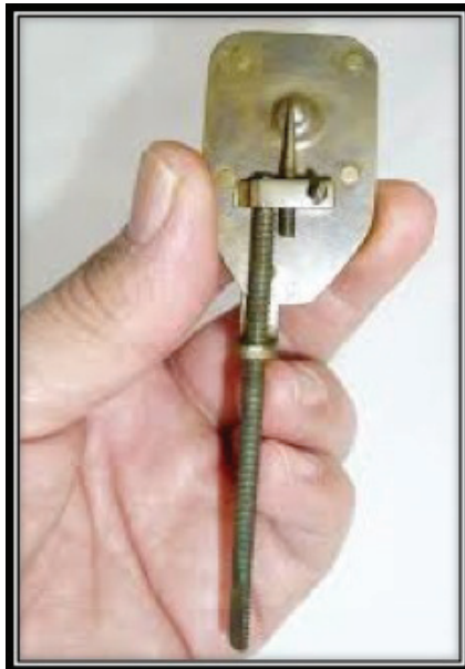
Figura 2. Microscopio simple (un solo lente) de Leeuwenhoek.
